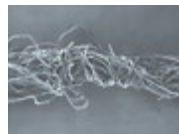
【オープンエンド糸】 繊維に隙間があり不均一でシャリ感を生む
