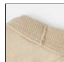
ヴィンテージライクを 再現する縫製仕様 バインダーネック結合部分 の生地をカットしたまま重 ね縫いしています。
